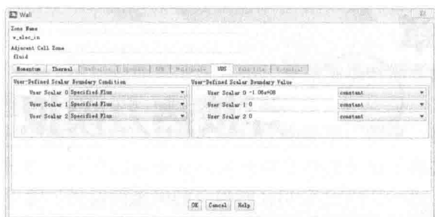
图 3-29 Wall 对话框 UDS 设定
